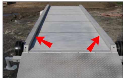
gangplank edge protection
